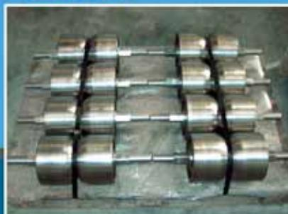
Cilindri in ghisa centrifugati a grafite nodulare con matrice perlitica
