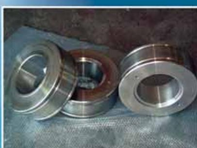
Cilindri in ghisa centrifugati a grafite nodulare con matrice a prevalenza aciculare
